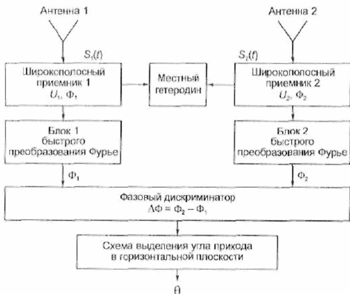
Рис. 6.25. Структурная схема широкополосного фазового интерферометра
