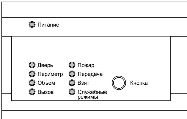
Рисунок 1. Внешний вид передатчика (надписи показаны условно)
